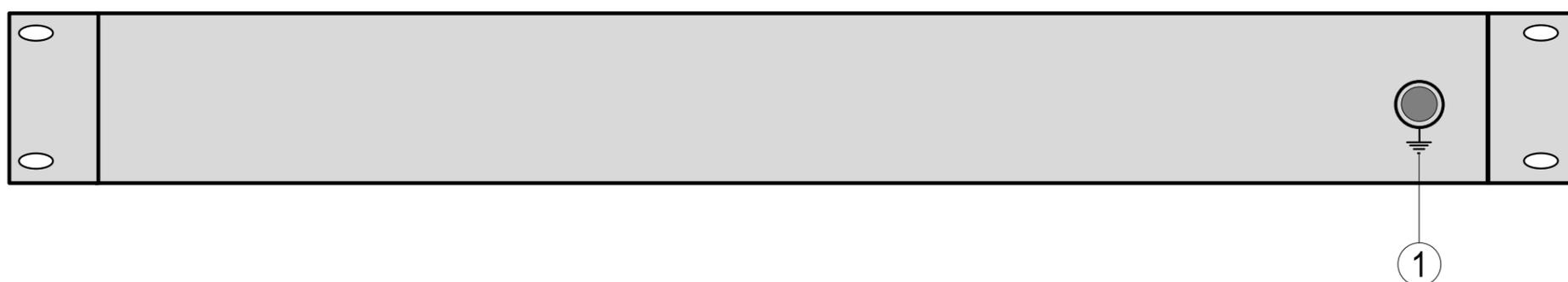
① - клемма подключения заземления
