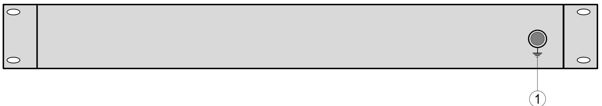
① - клемма подключения заземления
