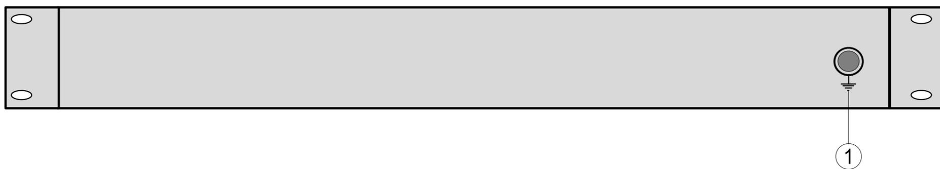
① - клемма подключения заземления
