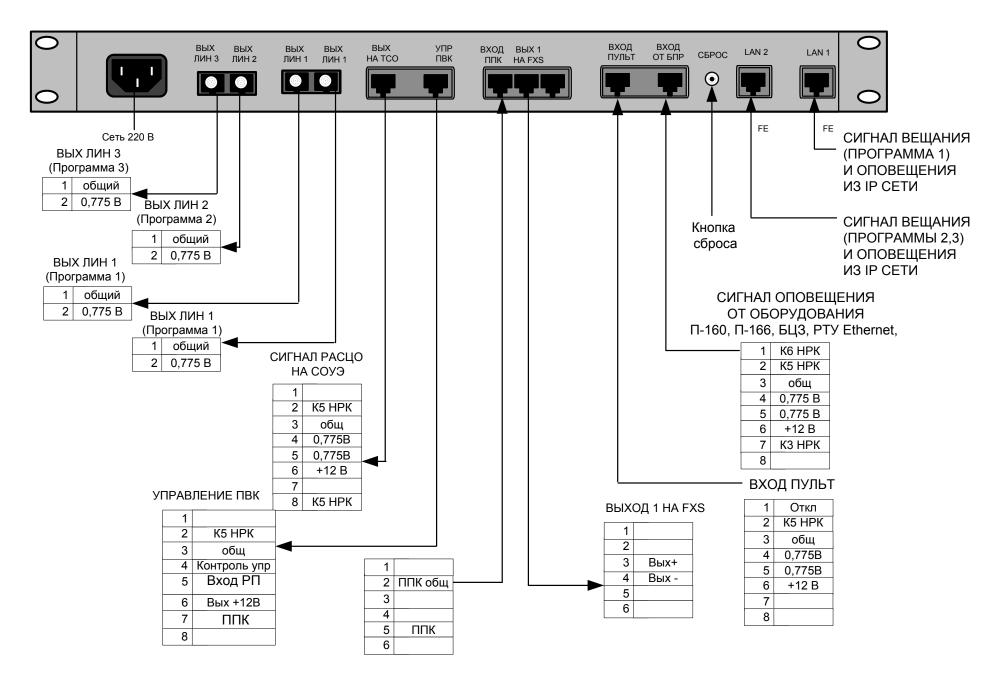
На задней панели усилителя-коммутатора расположены:
