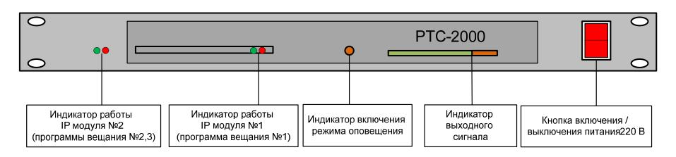
На передней панели усилителя-коммутатора расположены:
